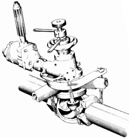
Figure 6-2. Globe Valve Reseter
