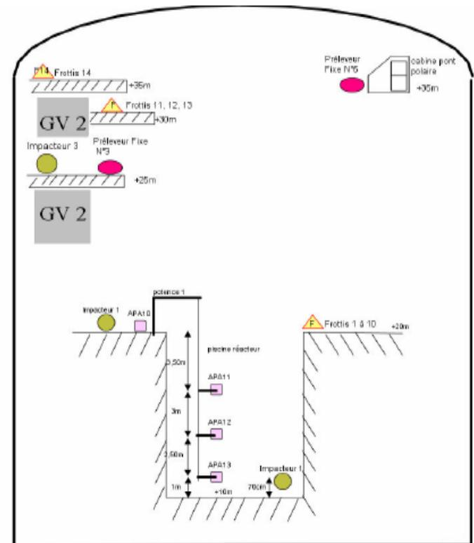
Schéma n°2 : Implantations des appareils de prélèvements dans le BR (vue en coupe). (Source : EDF)
